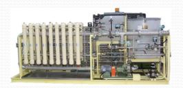
UF装置是电泳涂装设备中不可欠缺的附属设备,其发生问题,会导致工件清洗不净,涂料的回收率下降等质量问题。
